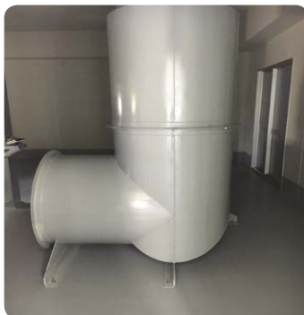
マンホール探索訓練用円筒管 縦抗
