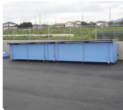
消防救助技術大会ほふく救助用 ほふく煙道
