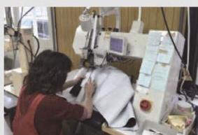
シーリングマシンによる防水加工
