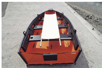
座席シートへの滑り止め加工により安定して担架やストレッチャーを乗せたまま運搬可能
