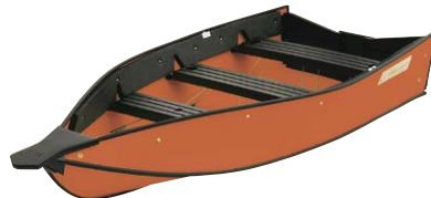
STEP3 座席など、残りのパーツを装着し完成。
