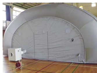
*陰圧装置を外部に設置
