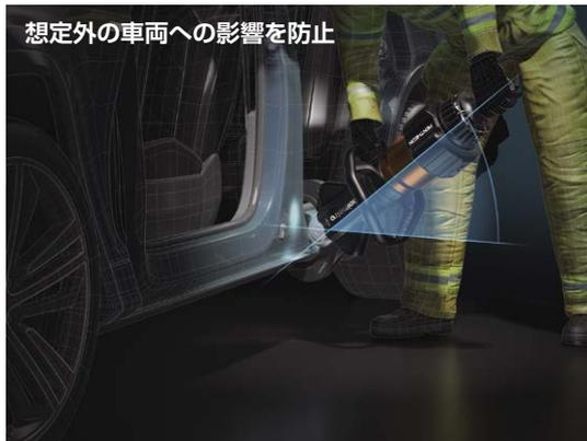
車両のサイドシルなど低い場所の切断が必要な場合に、インクラインドカッターであれば、カッターを地面に対して平行に位置する必要はありません。このことにより、要救助者の状態を悪化させてしまう可能性がある、ツールによる不用意な力や車両の移動を防止します。
