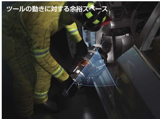
インクラインドカッターであれば、ツールと車両の間に30° 以上の作業スペースを作る事が可能となります。このことにより、ツールの内側への動きに対して多くの余裕スペースがある為、車内の要救助者への安全性を高め、カッター位置の再調整を排除できます。
