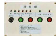
遠隔操作盤対応。消防 車両のボディ側面から ポンプ操作が行えます。
