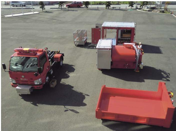
資機材・水槽・平ボディ(ダンプ付)コンテナ装備
