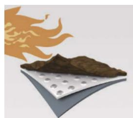
接炎すると着用者を防護する強固な遮熱層を形成します。熱と炎の曝露後もラミネートとシーム部の物理的な強度は曲げたりしても維持されます。
