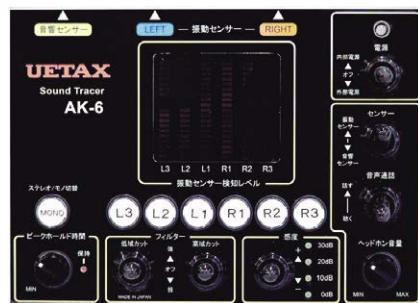
微弱な信号を増幅する入力感度切り替え機能があり、高音域、低音域をカットして雑音を下げ聞きやすくするフィルターを搭載しています。また一つのセンサーの検出音だけを集中して聴くためのセンサー選択や、ステレオ/モノラル切り替えも可能です。
