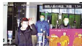
青枠内に入れれば瞬時に温度表示し、設定温度を超過した場合、顔の部分を赤く表示
