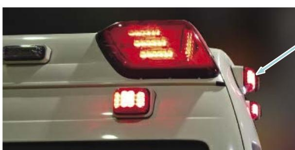
左右側方発光付きバックドア補助赤色点滅灯
