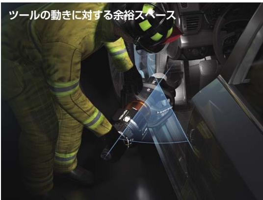
インクラインドカッターであれば、ツールと車両の間に30°以上の作業スペースを作る事が可能となります。
