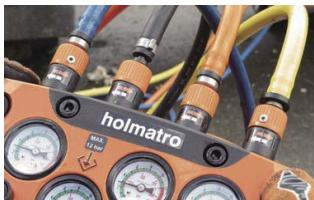
ホース離脱時の事故防止の為に、2ステップの操作でロック解除となるセーフティカプラーを採用しています。
