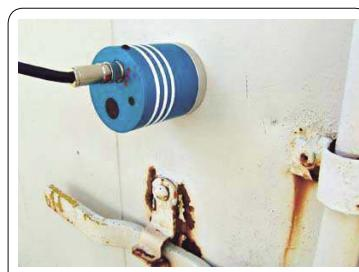
コンテナなどの金属壁面には、付属のマグネットを取り付け、内部の振動・音を検知することができます。
