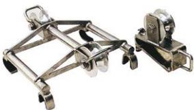
クレーン救出を迅速に行う際に設定。縮梯した3連梯子の上部と下段部に取付けます。許容荷重は200kgです。
