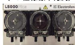
洗剤・撥水剤を自動的に計測・投入を行います。最適量の洗剤を効率よく投入することができ、経済的で手間を省力化できるシステムです。
