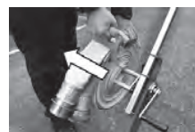
●ホースキャッチで取り外す
