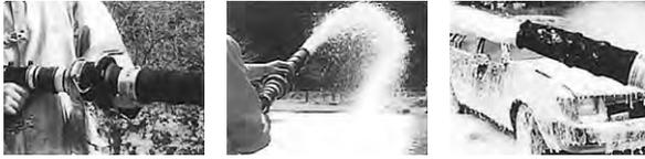
ノズル先端にアタッチメントとしてスピーディーに取り付けられ、しかも高性能な泡が得られます。また、ノズルの流量切り替え弁で、状況に応じた最適流量が得られます。本体は、大変軽量で機動性に優れています。
