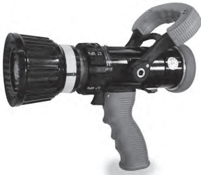
放水流量はダイヤルを回すことにより、現場状況に合わせて、0.7MPa（または0.5MPa）にて、OFF、約110、230、360、470L/minと自由に切り替えられます。これにより現場でのホースラインの状況に応じた流量設定が手元で簡単にできます。またノズル先端には独特のタービティース（回転歯）を備え、優れた自衛噴霧効果を創りだします。
