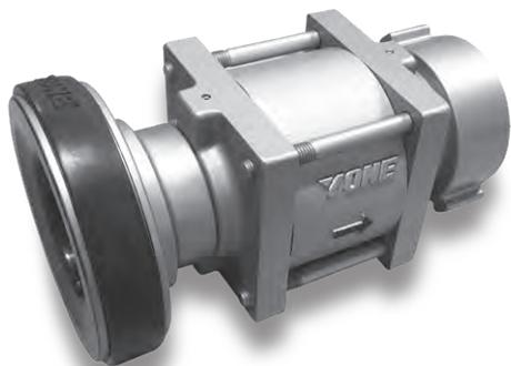
従来、消防車間のリレー送水時において、連成計を見ながらボールバルブを操作していましたが、このコントロールバルブの取り付けにより面倒な操作が一切不要となります。これにより、一度スロットルハンドルを設定しておけば、中継圧力が変化しても、制御バルブが必要水量に応じて自動的にバルブ開閉し、設定した放水圧力を保持できます。
